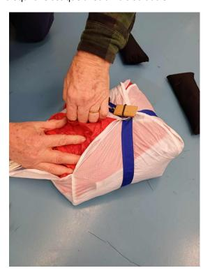
15) Formation des loves d'elevateurs en accordéon, sur la largeur du POD. Prendre des petits elastiques et ne pas trop les enfoncer a chaque pli de suspentes / les laisser aux extrémités. On fait cela jusqu'à laisser une longueur libre de +-1m d'élévateurs non repliés (ce qui donne du jeu en cas de lancement)
