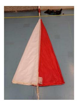
10) **Pliage du sapin**. On plie la moitié gauche du sapin en S par le dessus , et la moitié droite en S par le dessous (ou inversément). On arrive a un triangle plus allongé comme ceci :
