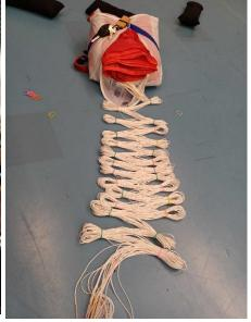
16) **Insérer les loves du suspentes dans le POD** (en partie avant) en les superposant les unes sur les autres (dans la réservation laissée à l'étape 13)
