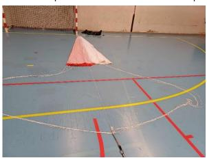
6) Séparer les suspentes à partir de la tete d'alouette qui accroche les suspentes au mousqueton. Prendre le meme nombre de suspentes dans chaque main et avancer vers le parachute. On peut secouer de bas en haut pour les demeler.
