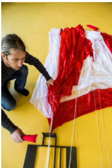
Fig. 71 Suspente #4 dans le séparateur
