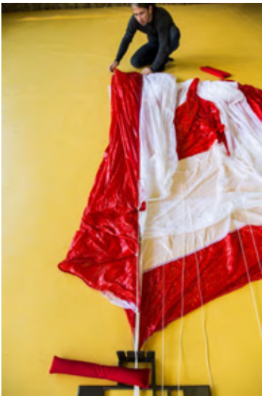
Fig. 74 Suspente dans le séparateur
