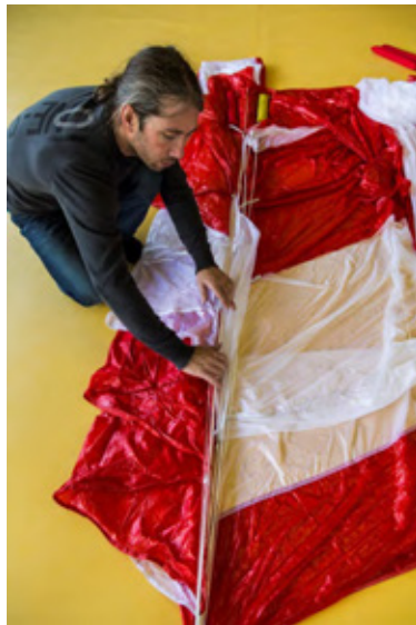
Fig. 78-79 Glissez l'excès de tissus dans les panneaux pliés
