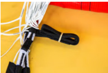
Fig. 134-137 Pliez le connecteur en quatre et attachez le avec un élastique
