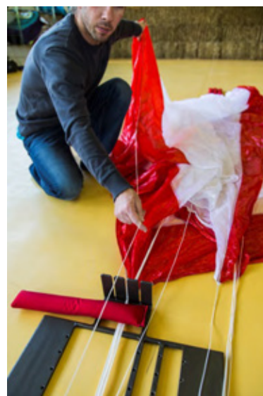
Fig. 55 Mettez cette suspente dans le séparateur (poids)
