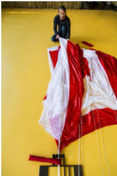
Fig. 68 Suspente du panneau #3 dans le séparateur
