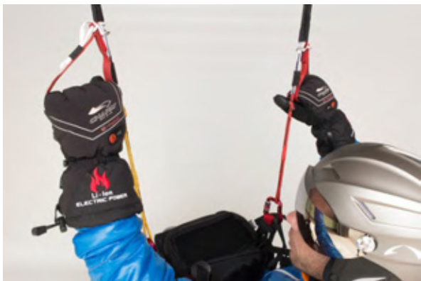
Fig. 1 Attache aux maillons principaux (pos. ventrale)
