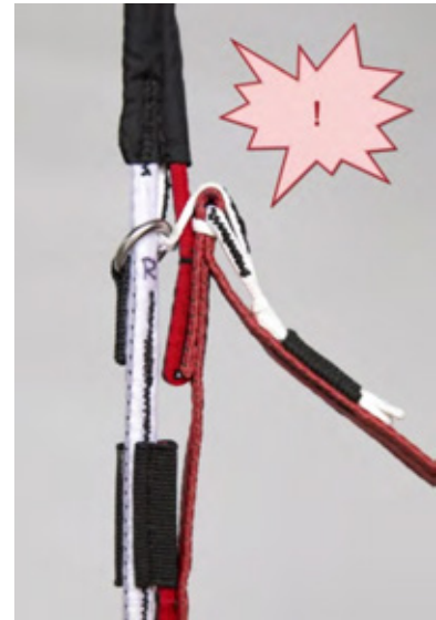
Fig. 16 portion rigide hors de l'anneau métallique!
