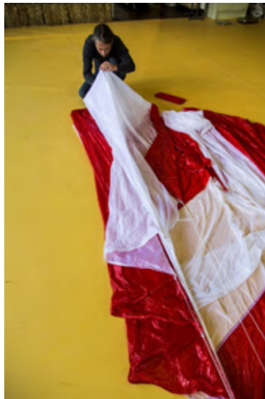
Fig. 75-77 Pliez les panneaux restants jusqu'au nez...
