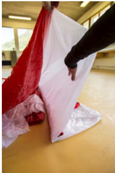
Fig. 69 Tendez le panneau #3 sur le côté. Diminuez le avec un pli
