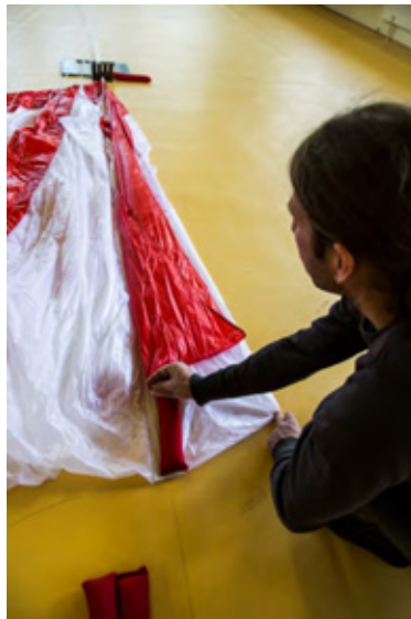
Fig. 57 Couture sur la suspente centrale
