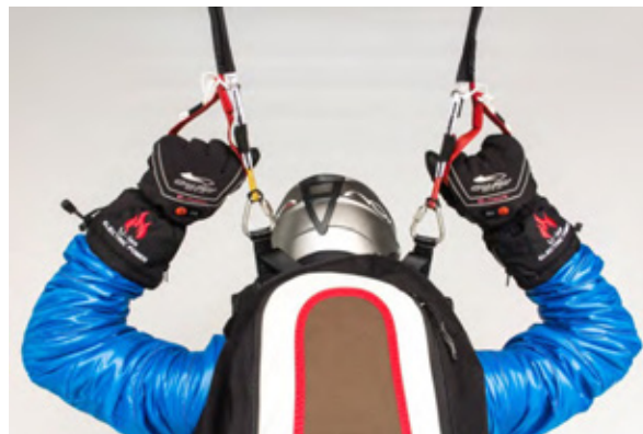
Fig. 2 Attache point d'ancrages prévus sur la sellette (généralement aux épaules)
