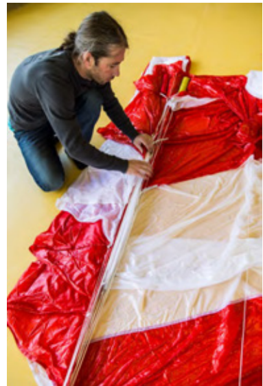
Fig. 78-79 Glissez l'excès de tissus dans les panneaux pliés
